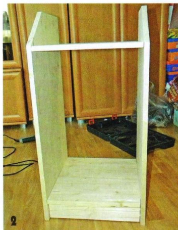
Каркас тумбочки сначала собрал без крышки.
