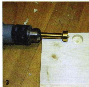
Гнёзда под мебельные петли должны быть выполнены с высокой точностью.
