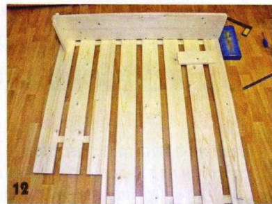
Громоздкую заднюю стенку вешалки удобнее собирать на полу.
