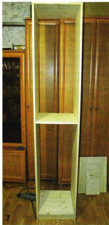
7 Пенал разделён пополам полкой, прикреплённой к боковым стенкам саморезами. Остальные полки — съёмные.
